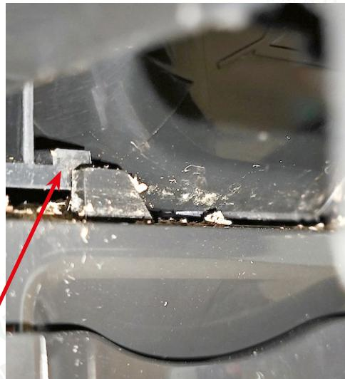
Wenn das Pulverfach herausgezogen ist, verhindert diese hintere Plastiknase, das Pulverfach herausgezogen werden kann.
