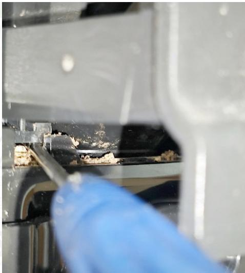
Diese Plastiknase mit einem Uhrmacher Schraubendreher nach oben hebeln, damit über den vorderen Anschlag darüber geht.
