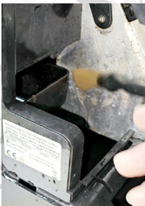
Wenn man die Wasserschale 5cm rauszieht, kann man die restliche Aluwand abwischen.
