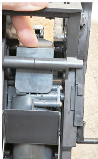
Unterer Wartungsdeckel wieder bei der Stellung „Brühgruppe bei Dichtung“ nach oben einschieben.
