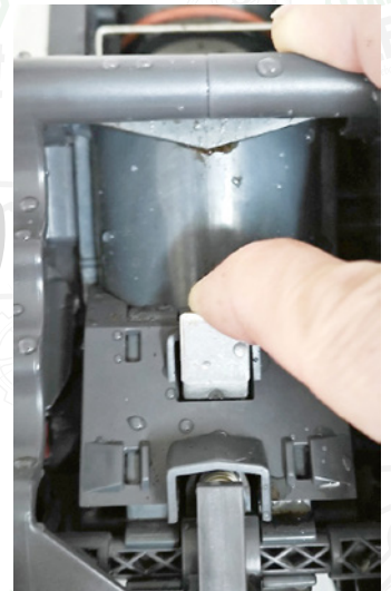
Dieser Bügel unter fließendem Wasser drücken, dabei spült man Kaffeereste aus. Ja, hier ist noch eine Wartungsklappe. Die ist aber schwer abzunehmen. Mach ich nur zum Service auf.
