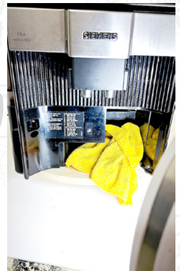
Auch von vorne in den Wasserschalen-schacht rein trocknen. Den Lappen nicht nur nach unten drücken, nein, auch nach oben mal reiben. Fertig.
